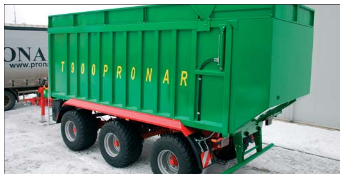
Náves T900 je vybavený výtlačným štítom a nosnosťou 23,5 t. Ideálne riešenie pre vyprázdňovanie v nízkych objektoch. Využitie nachádza aj pri zbere krmovín, kde je možné viac utlačiť hmotu a teda naložiť väčšie množstvo. Na snímke je náves, ktorý v deň našej návštevy naložili na kamión a smeroval k zákazníkovi na Slovensko.
