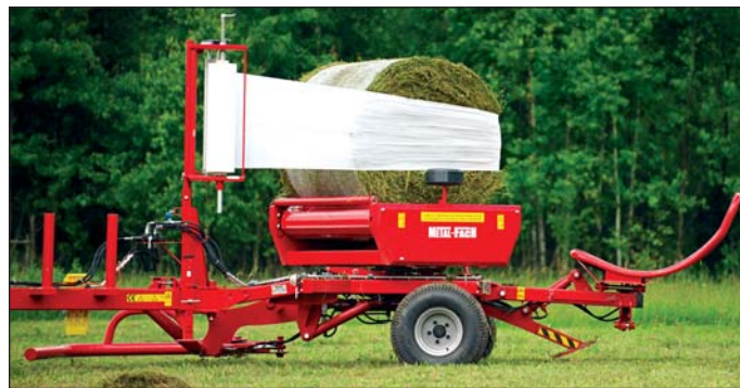
Všetky baličky Metal-Fach sú určené na prvé balenie balíkov s priemerom a šírkou 1,2 m a hmotnosťou až 1000 kg.
