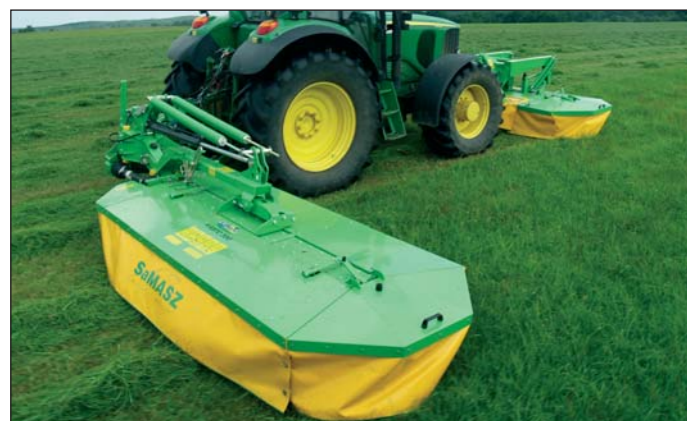
Bubnové kosenie SaMASZ sú dodávané v pracovných zábormach 1,35 – 3 m (zadná) a 2,1 – 3 m (predná).
