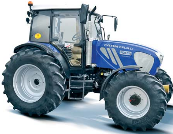
Farmtrac 9120 disponuje nominálnym výkonom motora 113 koní. Celková hmotnosť traktora atakuje 4,5 t.
